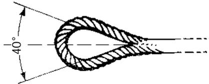
*Bei zu kurzen Schlaufen kann z.B. mit einem Vorläufer, der an einem Ende eine entsprechend vergrößerte Seilschleife und am anderen Ende einen kleineren Lashaken enthält, der zulässige Öffnungswinkel eingehalten werden.*
