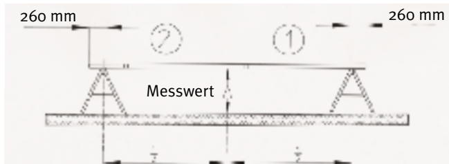
Bild 3: Unbelastete, umgesteckte Leiterteile
